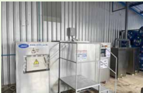
ภาพการติดตั้งเครื่องกำจัดเศษอาหาร
